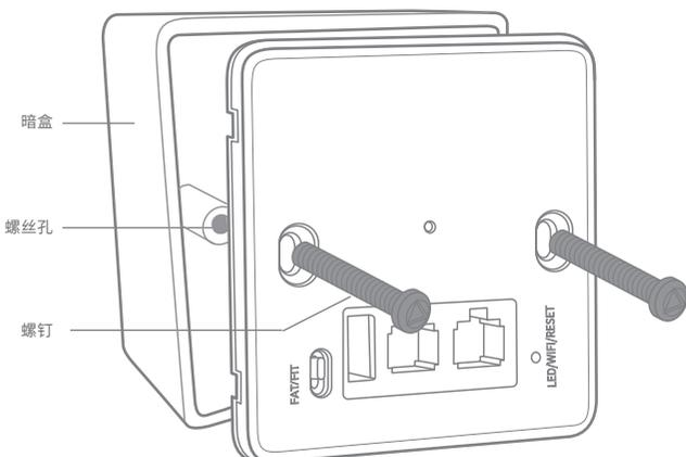
**4** 根据图示方向固定壳盖，完成安装。
